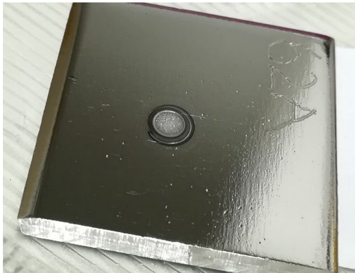
Kuva 3. Näytteessä oleva sputterointijälki GD-OES mittauksen jälkeen
