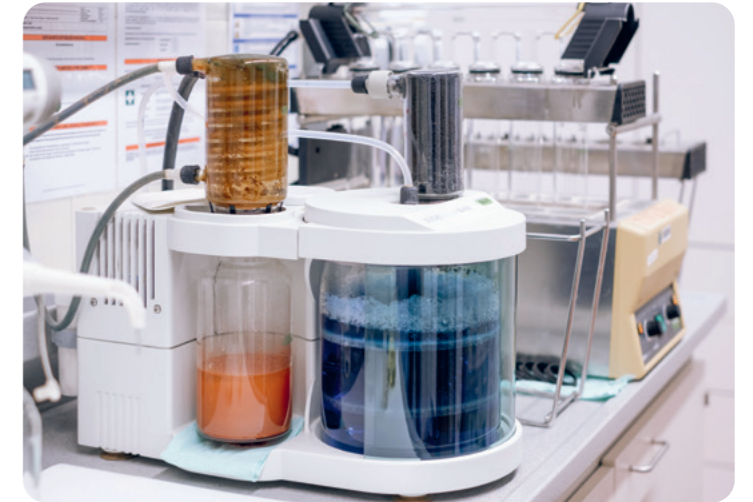
Kjeldahl-Aufschlusseinheit der Firma Büchi (Hintergrund) mit Scrubber (Vordergrund)
