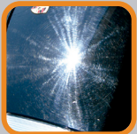
Riscos de lavagem
