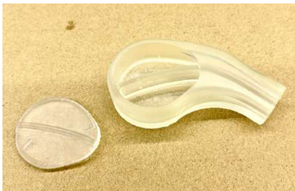
Figura 12. Impresión a escala 1:1 de la versión final del catéter, corrección de alturas y grosores e implementación de simbología en la parte superior de la tapa para la lectura correcta de la punción de las agujas para la máquina de hemodiálisis.
