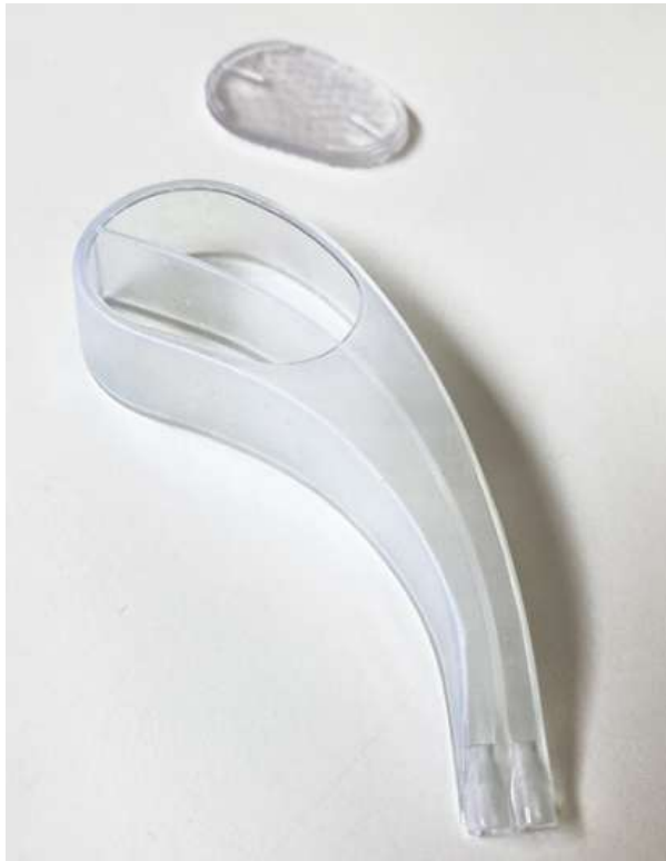
Figura 11. Impresión de la tercera versión del producto e implementación de simbología en la parte superior de la tapa para la lectura correcta de la punción de las agujas para la máquina de hemodiálisis.
