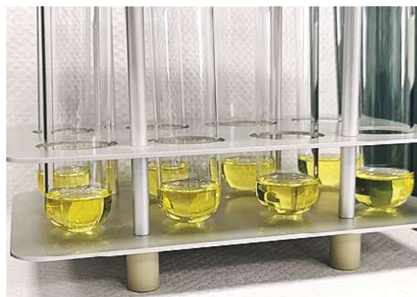
Figura 2. Muestras de aceite de nuez en los tubos de reacción del equipo Rancimat 892 (Metrohm) para la determinación de estabilidad oxidativa a 120 °C a diferentes condiciones.
