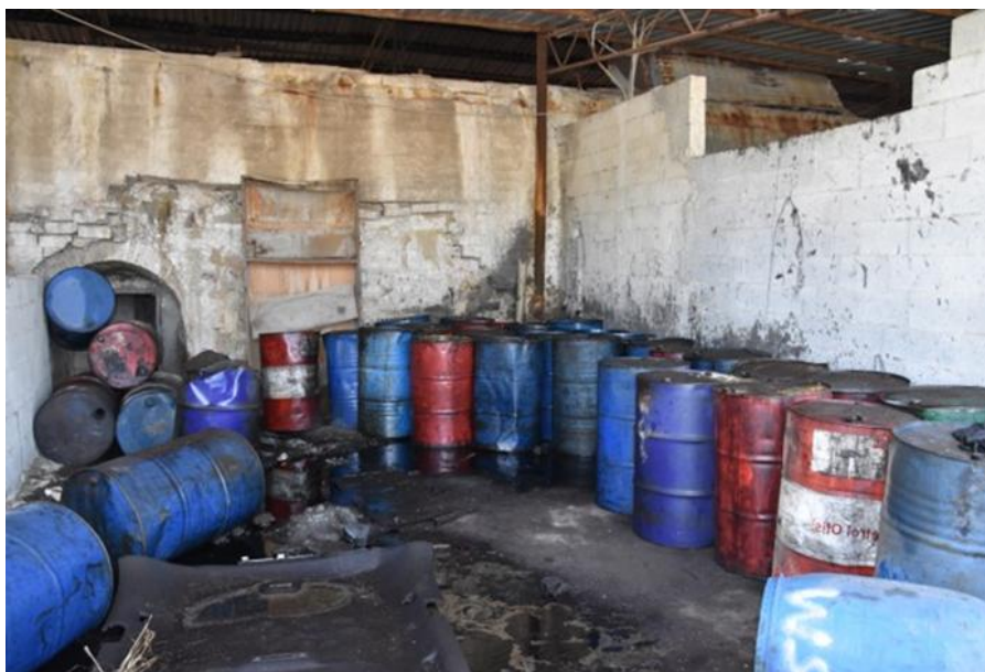
Figura 6. Condiciones inadecuadas de almacenamiento de bidones de productos químicos.
