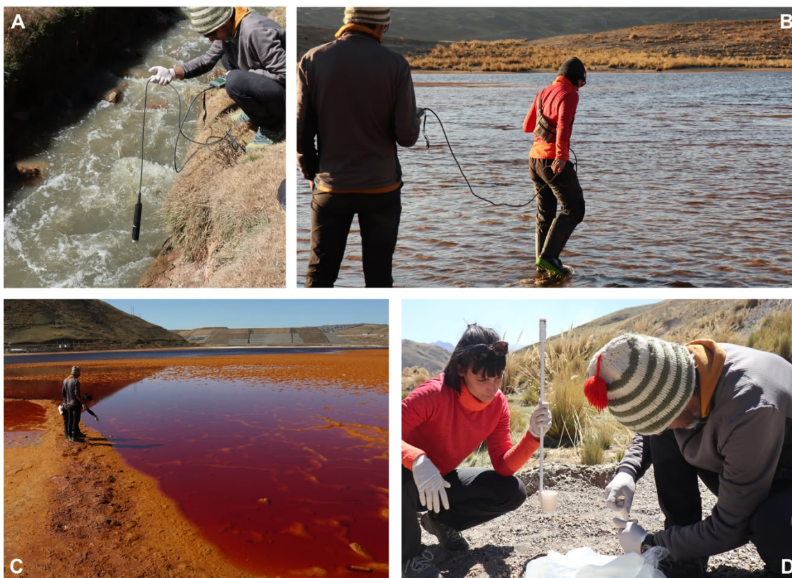
Figura 4. Vista general de las actividades y herramientas de muestreo. Los paneles A y B muestran el uso de la sonda multiparamétrica en el río Tingo y en la laguna Yanamate. Los paneles C y D ilustran la recolección de aguas superficiales mediante el muestreador de teflón en la laguna Quiulacocha y en el río Tingo.
