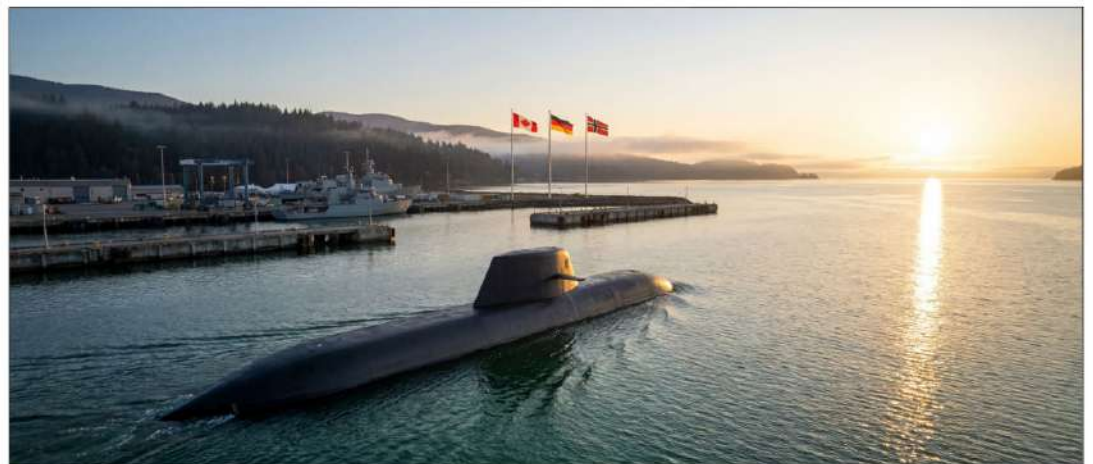
Die U-Boote der Klasse 212 CD sind ein gemeinsames Beschaffungsprogramm der norwegischen und der Deutschen Marine. Die Buchstaben „CD“ stehen für Common Design. Die U-Boote der Klasse 212 CD sind mit einer Länge von rund 73 m und einer Verdrängung von rund 2500 t wesentlich größer als die Boote der Klasse 212 A, auf der sie basieren.
