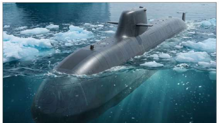
Die U-Boote der Klasse 212 CD sind ein gemeinsames Beschaffungsprogramm der norwegischen und der Deutschen Marine. Die Buchstaben „CD“ stehen für Common Design. Die U-Boote der Klasse 212 CD sind mit einer Länge von rund 73 m und einer Verdrängung von rund 2500 t wesentlich größer als die Boote der Klasse 212 A, auf der sie basieren.
