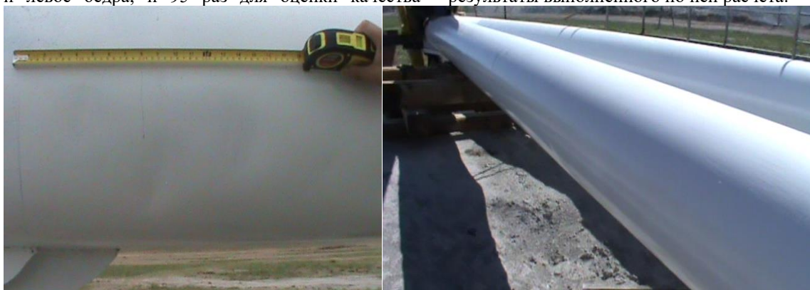
Рисунок-3. Места измерения в верхней части верхней секций. (продольные проводились в доль стрелы от нижней точки до верхнего блока, поперечные-от верхней до нижней).
