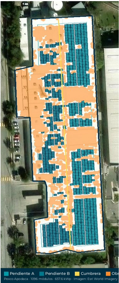
Fila 1 continua // borde largo (rumbo 177°). Setback 5 m (línea teal). Cable ~4° az 87°/267°. Portrait, largo // costuras (S-5l). No sustituye visita técnica.
