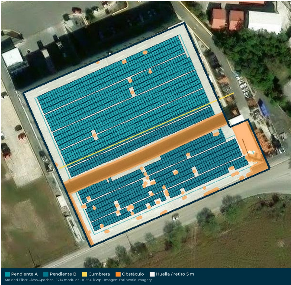
Fila 1 continua // borde largo (rumbo 67°). Setback 5 m (línea teal). Gable ~4° az 337°/157°. Portrait, largo // costuras (S-5l). No sustituye visita técnica.
