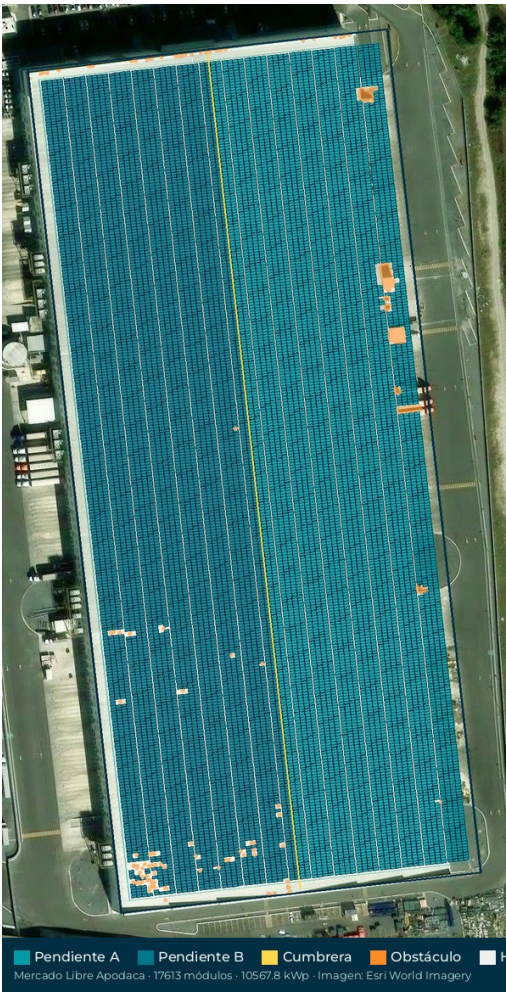
Fila 1 continua // borde largo (rumbo 174°). Setback 5 m (línea teal). Gable ~4° az 84°/264°. Portrait, largo // costuras (S-5). No sustituye visita técnica.
