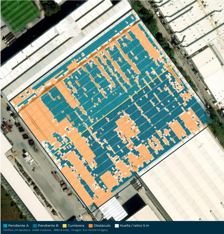
Fila 1 continua // borde largo (rumbo 54°). Setback 5 m (línea teal). Gable ~4° az 324°/144°. Portrait, largo // costuras (S-Sl). No sustituye visita técnica.
