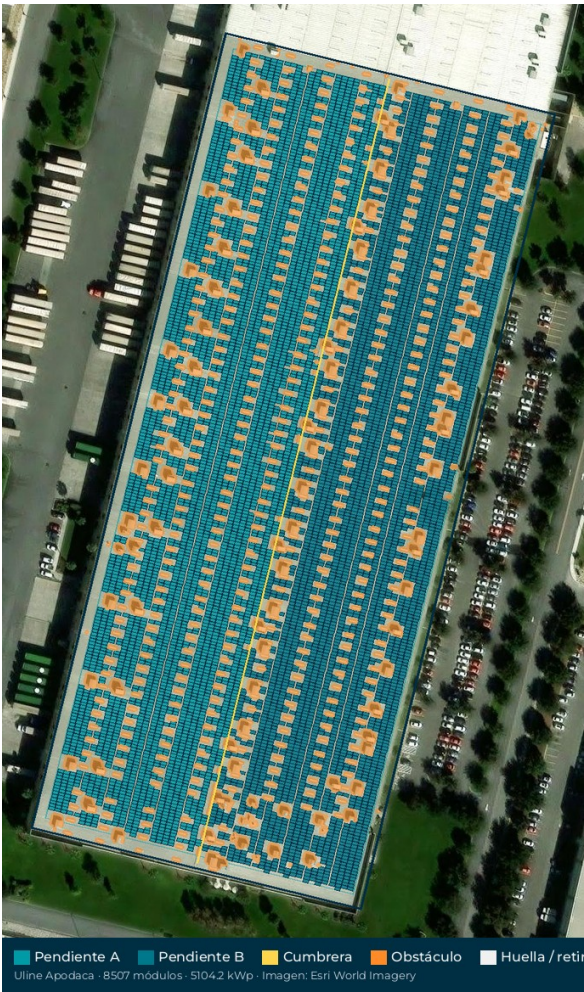
Fila 1 continua // borde largo (rumbo 14°). Setback 5 m (línea teal). Gable ~4° az 284°/104°. Portrait, largo // costuras (S-5l). No sustituye visita técnica.
