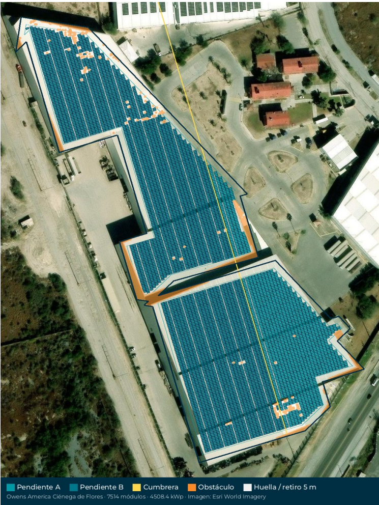
Fila 1 continua // borde largo (rumbo 164°). Setback 5 m (línea teal). Gable ~4° az 74°/254°. Portrait, largo // costuras (S-Sl). No sustituye visita técnica.
