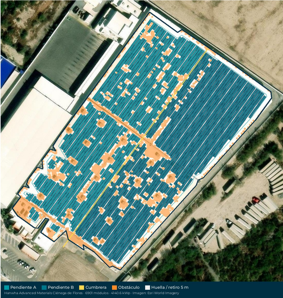
Fila 1 continua // borde largo (rumbo 37°). Setback 5 m (línea teal). Gable ~4° az 307°/127°. Portrait, largo // costuras (S-5l). No sustituye visita técnica.
