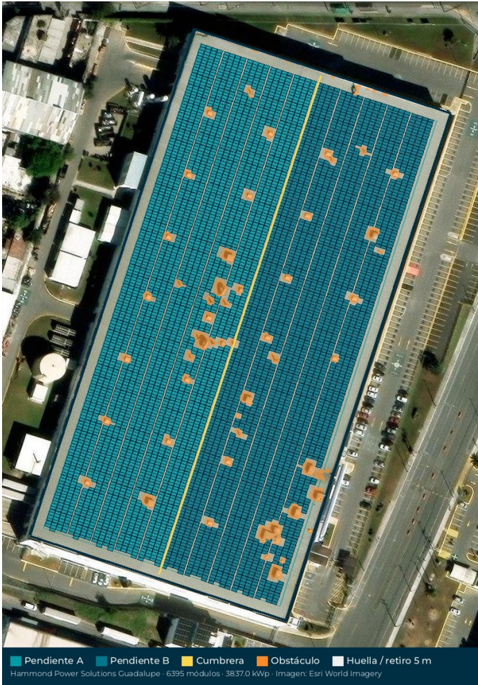
Fila 1 continua // borde largo (rumbo 19°). Setback 5 m (línea teal). Gable ~4° az 289°/109°. Portrait, largo // costuras (S-5!). No sustituye visita técnica.
