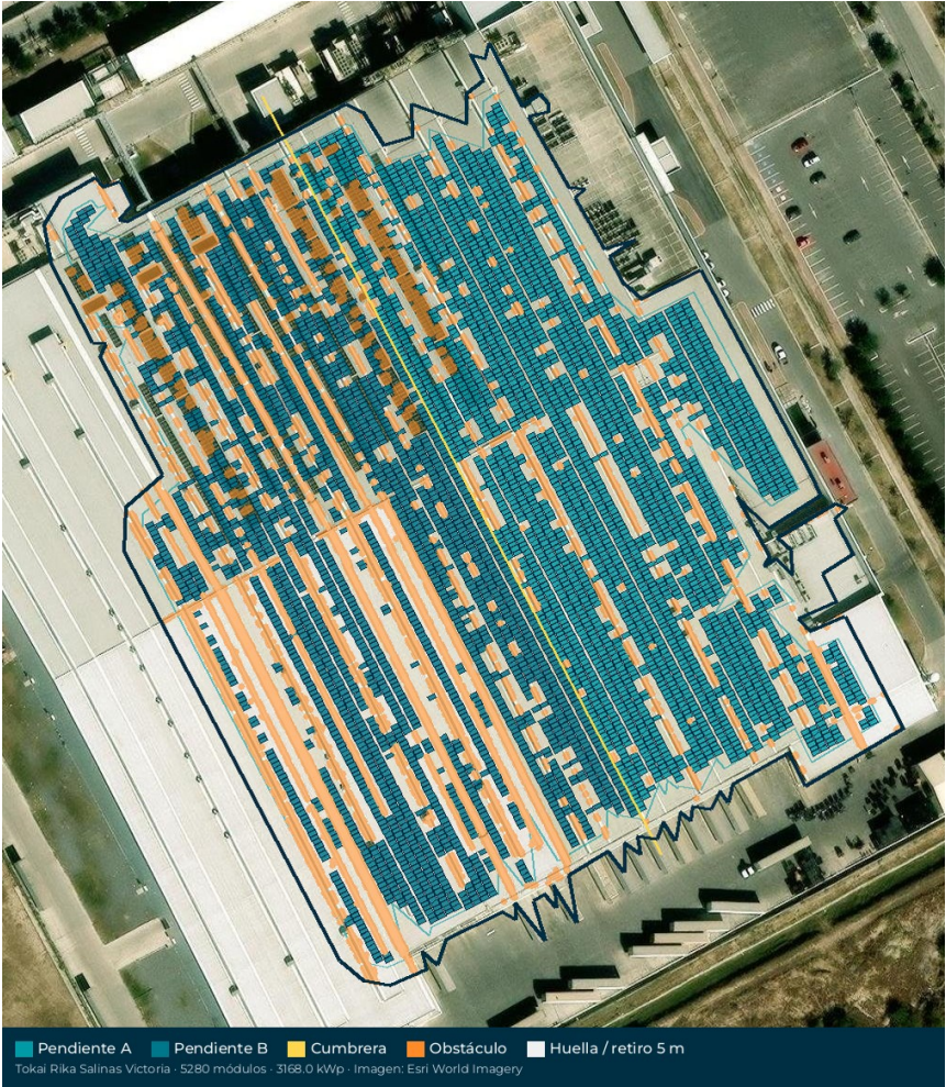
Fila 1 continua // borde largo (rumbo 153°). Setback 5 m (línea teal). Cable ~4° az 63°/243°. Portrait, largo // costuras (S-5l). No sustituye visita técnica.
