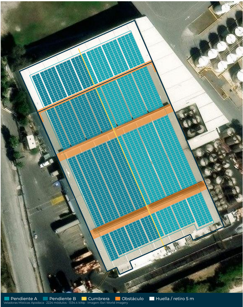
Filas paralelas al edificio. Margen a las orillas de 5 m (línea turquesa). Techo de dos aguas, inclinación de unos 4°. Fijación sin perforar la lámina. No sustituye visita técnica.
