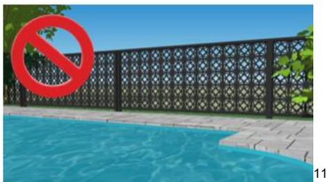
Figure 14 Exemple de clôture dont les travers horizontaux sont trop rapprochés et peuvent être escaladés facilement
