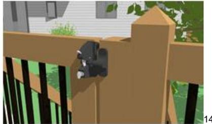
Figure 17 Exemple de loquet pouvant être installé du côté extérieur de l’enceinte, même lorsque celle-ci mesure moins de 1.5m de haut.
