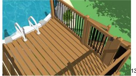
Figure 16 Exemple de loquet permettant de se verrouiller automatiquement. La porte devrait aussi être munie de pentures à ressort afin de se refermer automatiquement.
