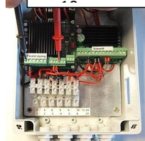
Actuator 2, aansluitpolen 1 en 11 + 1
