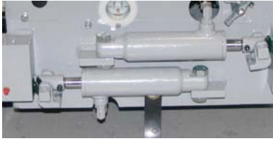
Systeem met rempennen (indien aanwezig)
