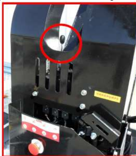
Figuur 10c. Begin eerst met het inschuiven van de mast
