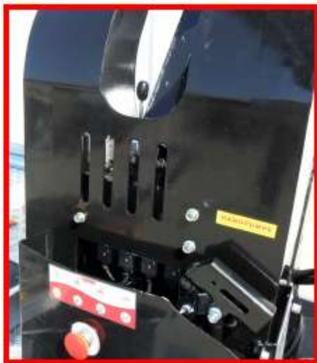
Fig. 9 Noodhandpomp en noodstop
