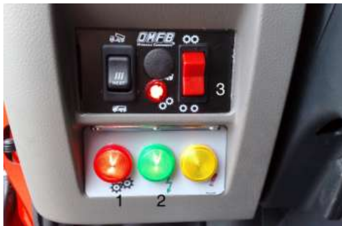
Figuur 8b: binnen in de cabine met elektrisch inschakelbare P.T.O.
