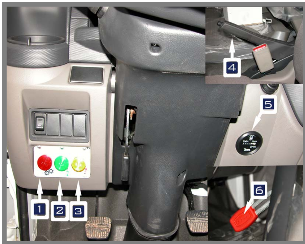
Figuur 8a: binnen in de cabine met manuele inschakeling voor de P.T.O.
