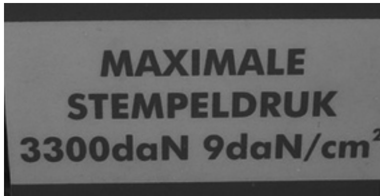
Figuur 28: Maximale belasting en druk op de stempelpoten.
