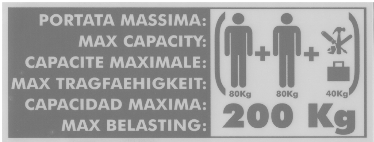
Figuur 18: Max. gewicht in de werkbak
