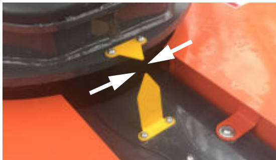
Basis/knikarm uitlijnen – Visuele indicator
