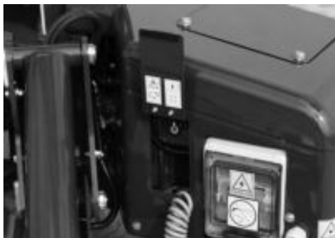
Fig. 132 Aansluitdoos in ruimte met elektrische componenten.
