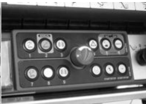
Fig. 62 Noodstop op de afstandsbediening
