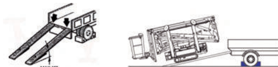
Fig. 171 Met oprijplanken laden
