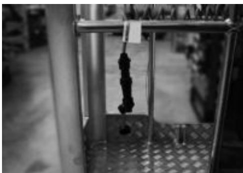
Fig. 155 Serviceaansluiting op hoogwerkerbak
