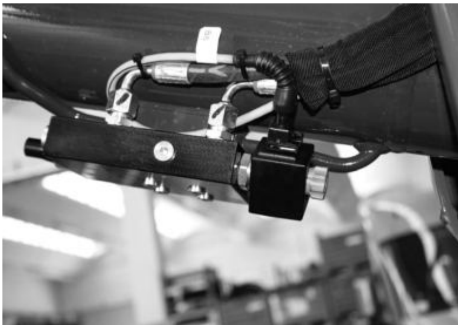
Fig. 67 Elektrokleppen voor de nooddaling wegens ernstige situatie
