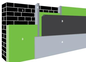
1. Buitenumuur | 2. Isolatie | 3. Vochtscherm | 4. Afwerkingslaag | 5. Stijl- en regelwerk (optioneel)
