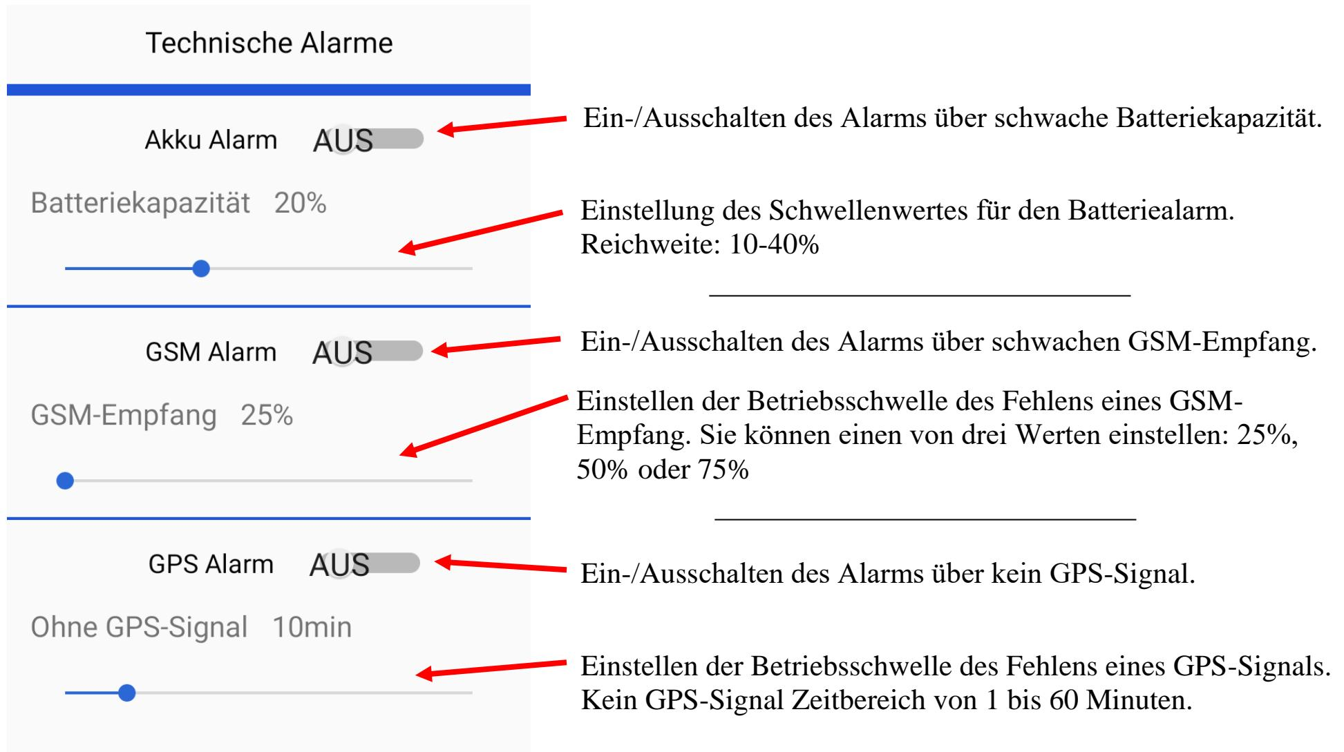
Nach der Aktivierung eines bestimmten technischen Alarms – wenn der eingestellte Wert überschritten wird, erhalten Sie eine SMS über den Alarm.
