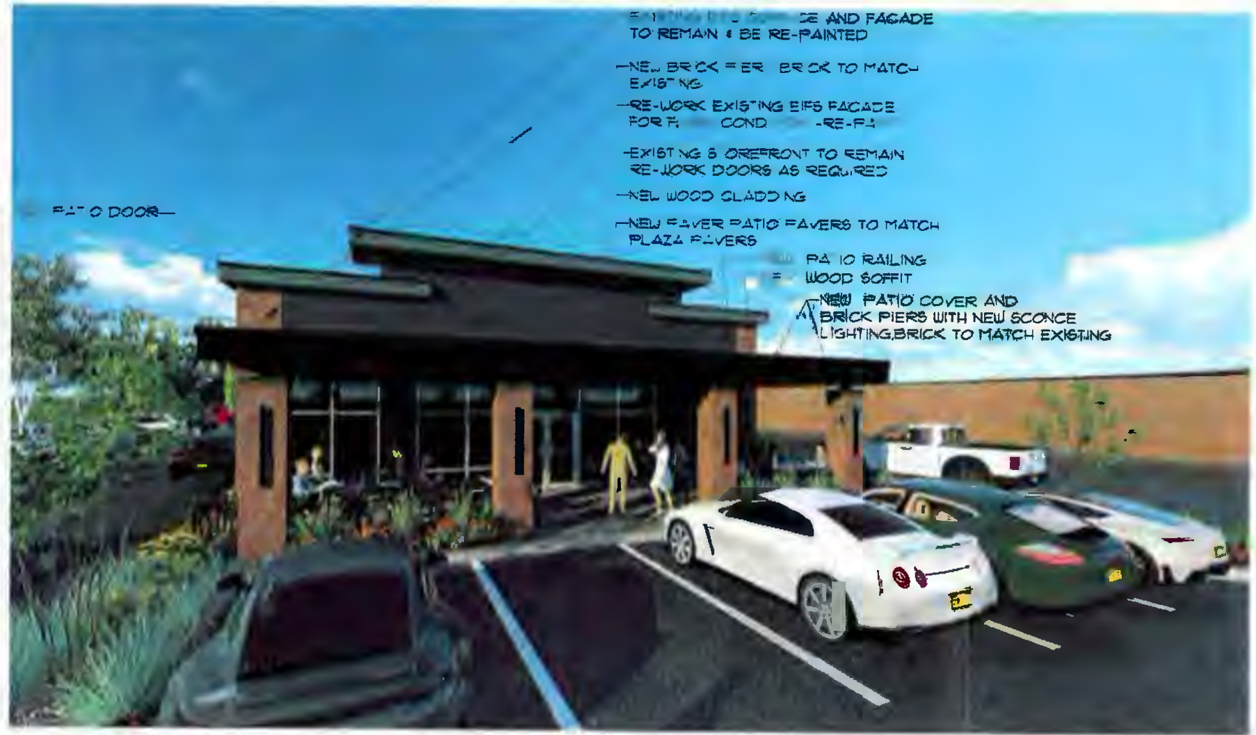
1 NORTH ELEVATION SCALE: 1/8" = 1'-0"
