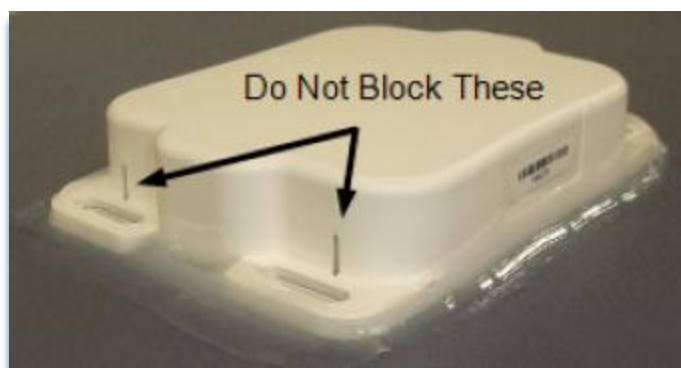
Figura 5. Fijación antena Satelital
