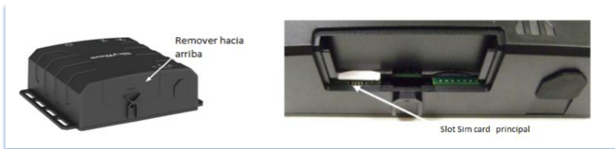
Figura 11. Instalación sim card
