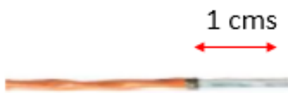
Figura 7. Corte recubrimiento cable
