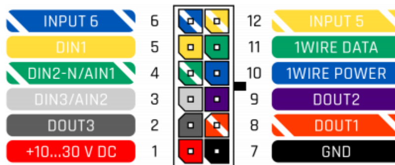
Figura 2 Descripción del Conector del FMU130
