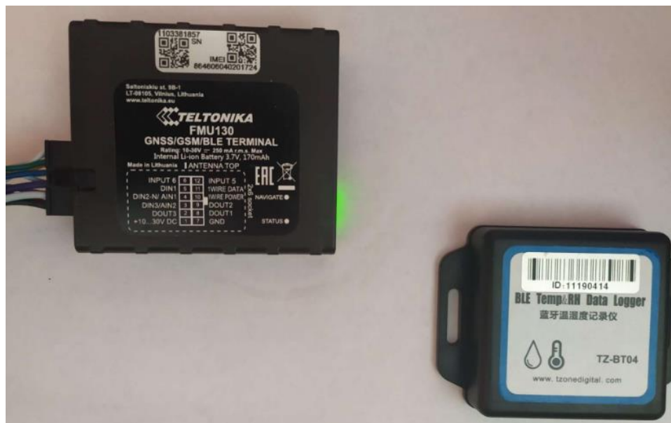
Figura 2. Sensor con equipo FMU130
