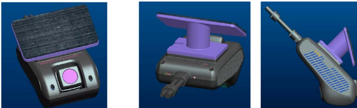
Figura 17 Base de montaje para vehículos pesados
