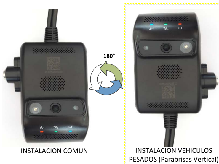
Figura 18 Orientación de Instalación del JC200 si no se cuenta con base de montaje para vehículos pesados
