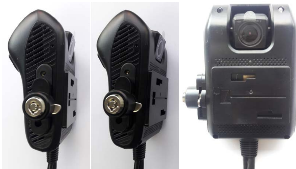
Figura 19 Ajuste de cámara delantera JC200 si no se cuenta con base de montaje para vehículos pesados
