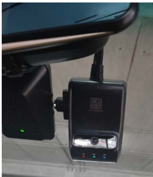
Figura 16 Estado de los LEDs del JC200 enlazado
