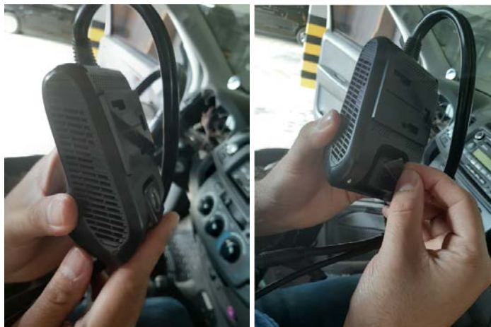
Figura 11 Ajuste del ángulo de grabación de la cámara frontal
