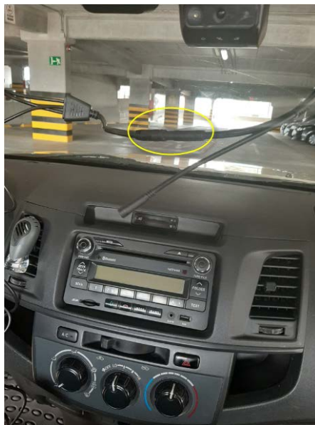
Figura 13 Conexión del arnés al equipo JC200
