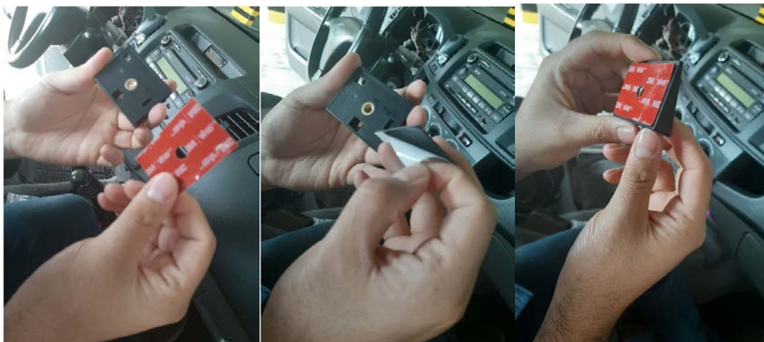
Figura 9 Colocación de adhesivo doble cara 3M en base para montaje
