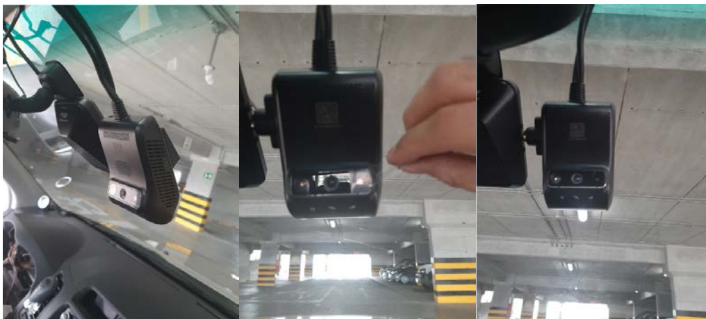
Figura 12 Colocación del equipo JC200 en la base de montaje
