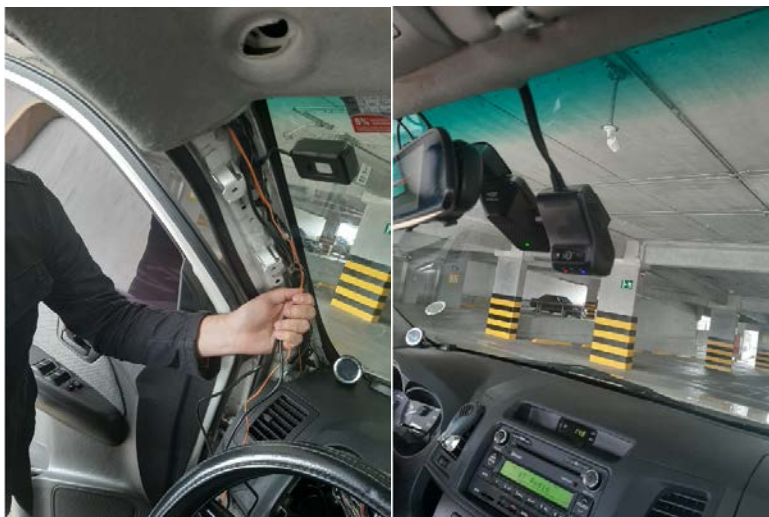
Figura 15 Distribución del cableado del equipo JC200 en el vehículo
