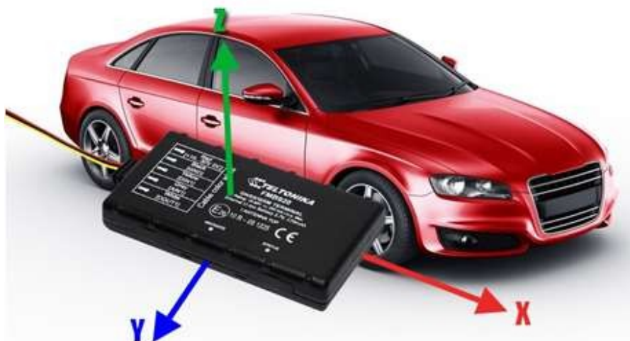
Figura 7. Orientación del dispositivo FMC920 en el lugar de instalación
