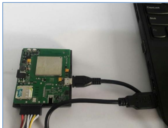
Figura 4 Conexión del dispositivo FMC130 a la PC
