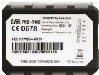
El dispositivo se debe ubicar con los led's vista hacia el cielo (tal como se ubica la antena GPS en los dispositivos Skytrack, si el equipo se ubica de medio lado o con los led's hacia abajo se van a presentar fallas o dificultades con el enlace GPS)
