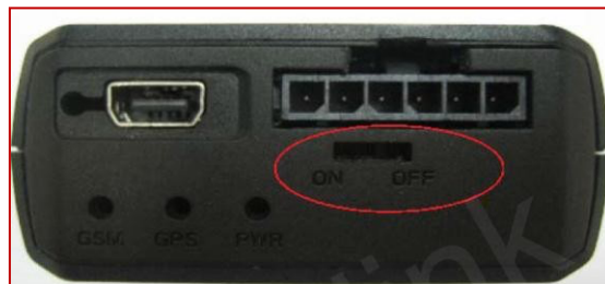
Figura 4. Switch de carga
