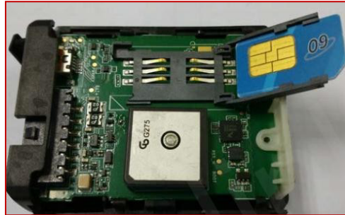
Figura 2. Instalación sim card
