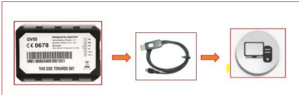
Figura 6. Conexión para carga de FW.
