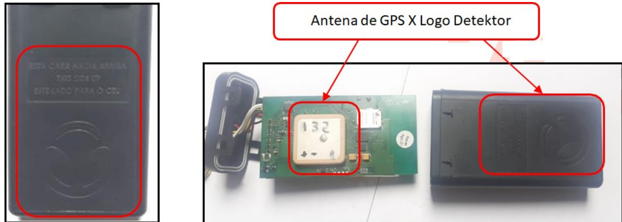
Figura 3. Ubicación cara antena GPS.
