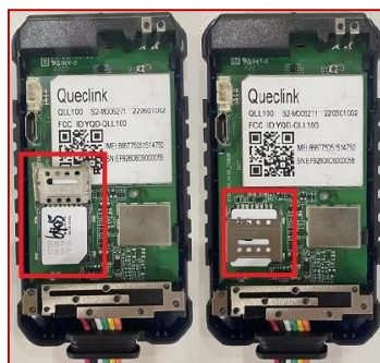
Figura 2. Instalación sim card
