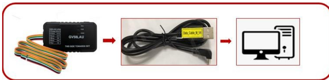
Figura 5. Conexión equipos actualización de FW
