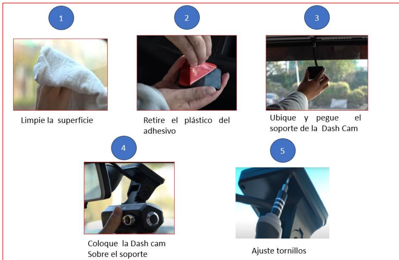
Figura 5. Fijación de Dash Cam
