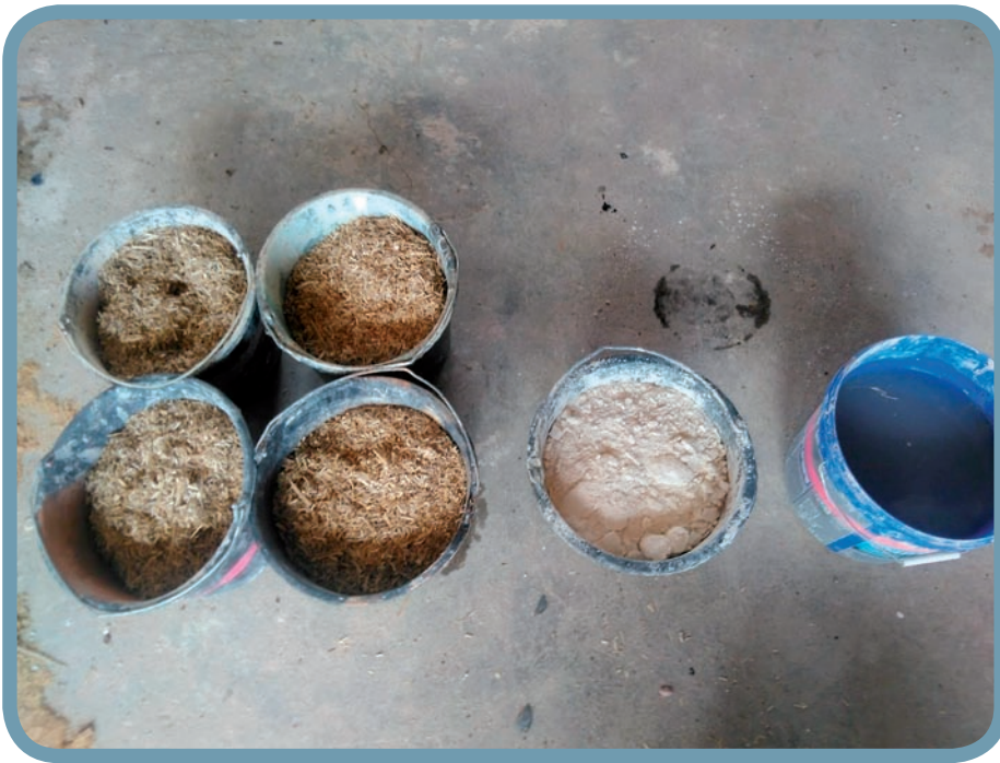
Typische Dosierung von Hanfkalk in Raumteilen: 4 Teile Hanfschäben, 1 Teil Kalk-Bindemittel, 1 Teil Wasser. © Dr. Norbert Höpfer
