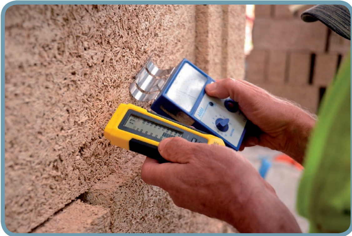
Hanfalksteine werden nach dem Aushärten mit einem Feuchtemessgerät kontrolliert. © Felix Drewes, Klimapraxis
