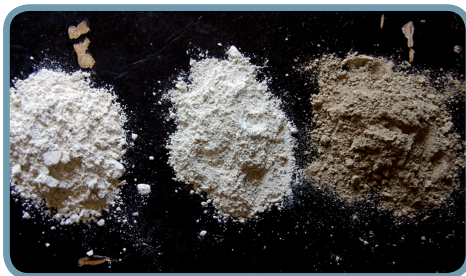
Kalk-Bindemittel von links nach rechts: Luftkalk CL 90, natürlich hydraulischer Kalk NHL, Romanzement. © Dr. Norbert Höpfer
