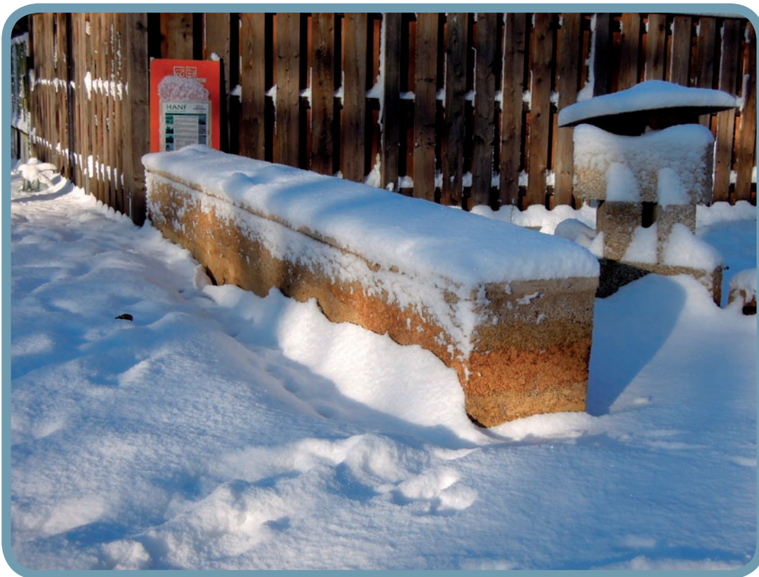
Hanf-Sitzbank im brandenburgischen Dorf Zempow, Winter 2022 bis 2023. Diese Bank dient als Extremtest und hat bisher zwei Winter mit Frost-Tau-Wechseln schadlos überstanden. Das Experiment veranschaulicht die Haltbarkeit von Hanfkalk. Dennoch wird für Außenwände stets ein Kalkputz als Witterungsschutz empfohlen. © Dr. Norbert Höpfer.
