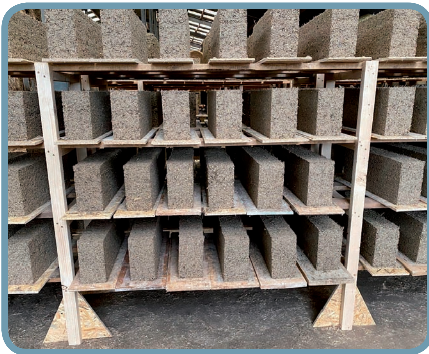
Hanfsteine im Trockenregal zum Aus- härten auf der Bioranch Zempow. © Wilhelm Schäkel, Bioranch Zempow
