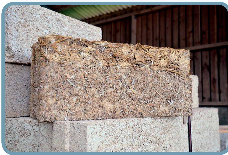
Oben: Hanfstein mit weniger Bindemittel und geringerer Rohddichte. Unten: Hanfstein mit mehr Bindemittel und höherer Rohddichte. © Dr. Norbert Höpfer
