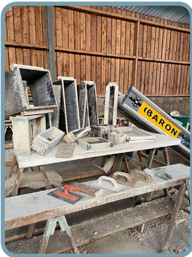
Werkzeug-Übersicht: Schalungen, Holzhämmerchen, Deckelbretter, Kellen und Förderband. © Felix Drewes, Klimapraxis
