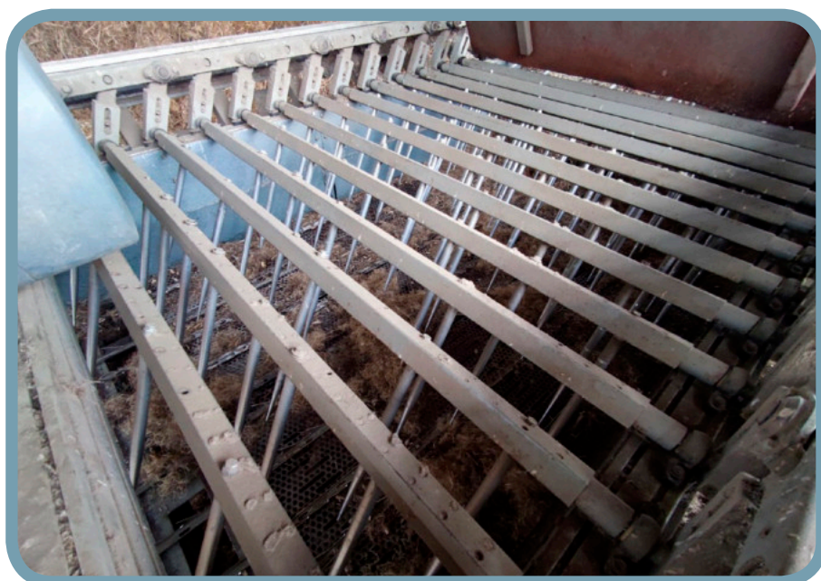
Detailaufnahme Sieb und Zinken der Kammschüttel – die am unteren Sieb eingebrachten Sieblöcher (15 x 6 mm) lassen die Schäben passieren, während die Zinken die längeren Fasern oberhalb zurückhalten. © Bio Ranch Zempow / Klimapraxis
