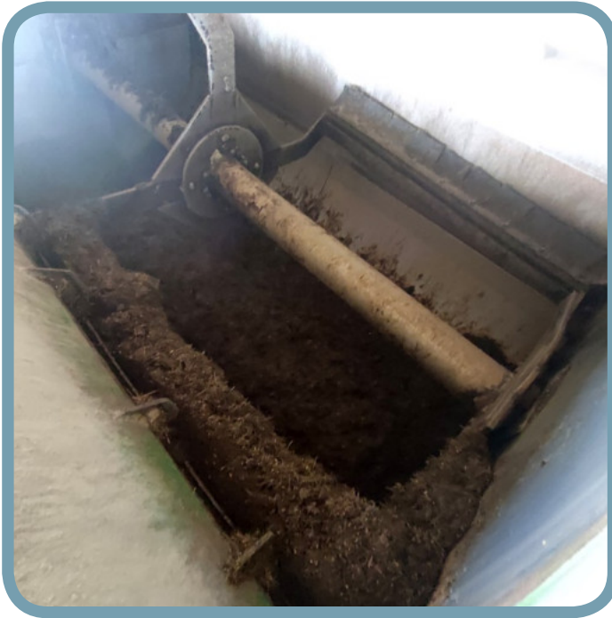
Futtermischwagen mit Schäben, Branntkalk und Wasser bei der Kalkummantelung (Coating) in Zempow – Innenansicht des Mischraums. © Bio Ranch Zempow
