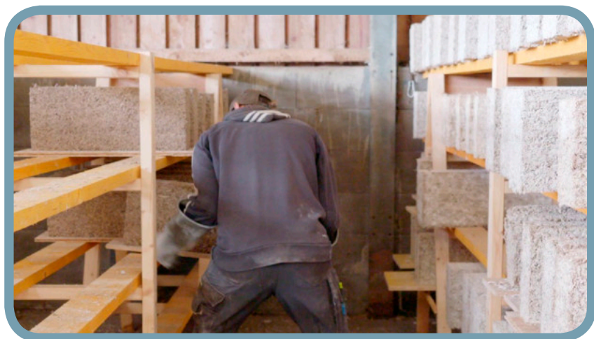
Hanfalk-Stein wird nach dem Ausschalen ins Trockenregal zum Aushärten gelegt. © Klimapraxis
