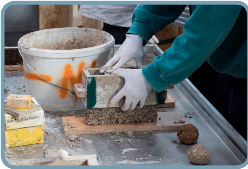
Sonderformat-Block in einer Holzschalung. © Klimapraxis / Bio Ranch Zempow
