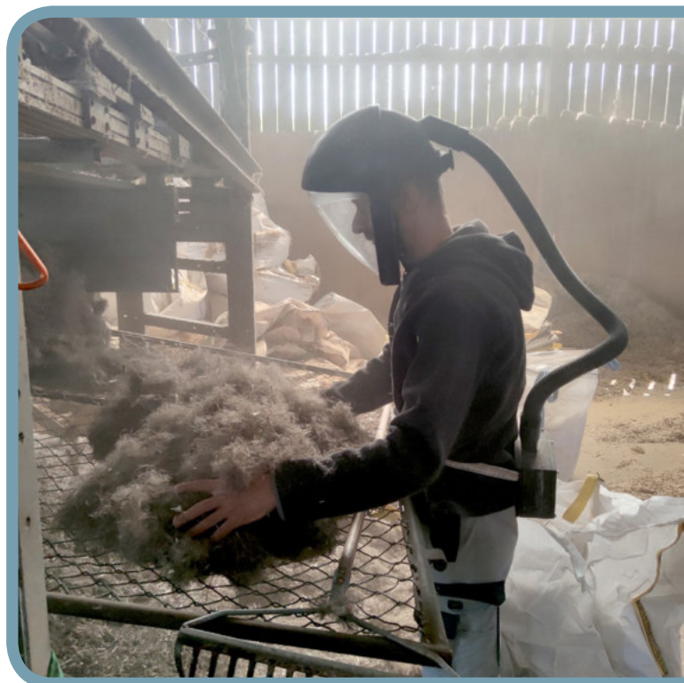
Faser-Schäben-Trennung an der Kammschüttel auf der Bio Ranch Zempow links: Wilhelm Schäkel gibt das Faser-Schäben-Gemisch händisch in die Kammschüttel rechts: Abnahme der Faserfraktion am Auslauf mit Staubmaske wegen hoher Staubentwicklung. © Bio Ranch Zempow / Klimapraxis
