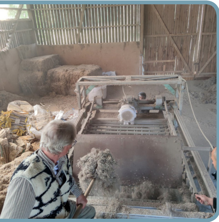
Faser-Schäben-Trennung an der Kammschüttel auf der Bio Ranch Zempow links: Wilhelm Schäkel gibt das Faser-Schäben-Gemisch händisch in die Kammschüttel rechts: Abnahme der Faserfraktion am Auslauf mit Staubmaske wegen hoher Staubentwicklung. © Bio Ranch Zempow / Klimapraxis
