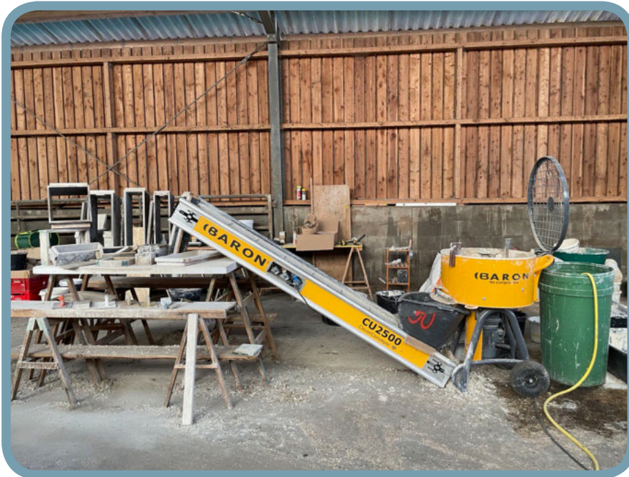
Produktionslinie der Bioranch Zempow mit BARON-Zwangsmischer und CU2500-Förderband in der Stallhalle. © Klimapraxis
