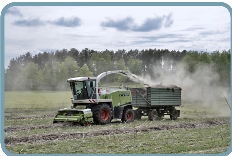
CLAAS Jaguar Feldhäcksler mit Anhänger beim Aufnehmen des Winterhanf-Schwads und Ablage auf dem Hänger. © Bio Ranch Zempow
