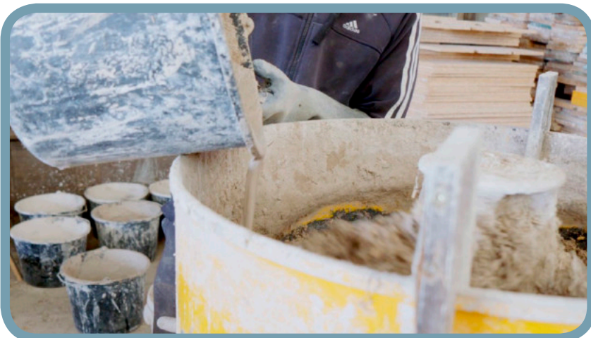
Mischvorgang mit Kalk- und Wasserzugabe im Zwangsmischer. © Klimapraxis
