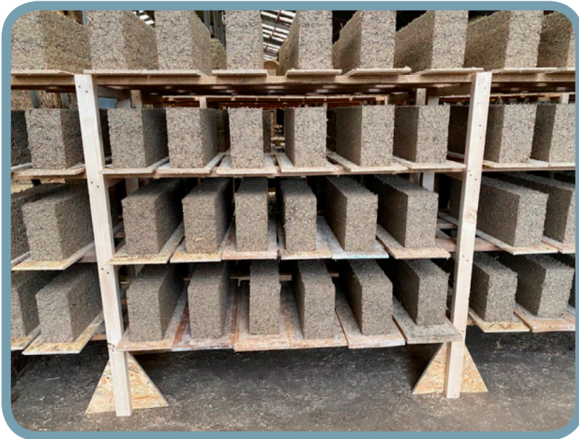
Trockenregale mit aushärtenden Hanfkalk-Steinen. © Bio Ranch Zempow
