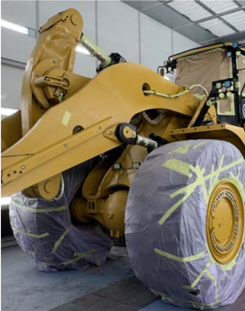
Hver minste detalje folieres og tildekkes før lakking og tectylering.
