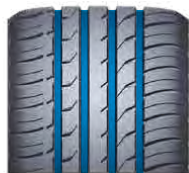
Vier umlaufende Profiltrillen mit schmalen Innenrillen verbessern die Wasserverdrängung.
