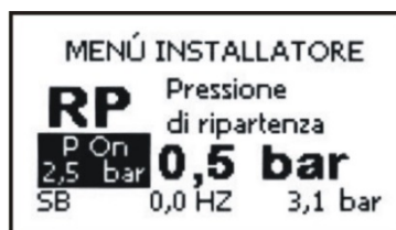
Afbeelding 18: instelling van de druk voor herstart
