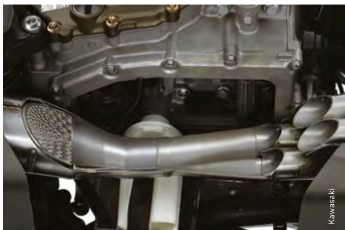
Ook een katalysator dempt.
