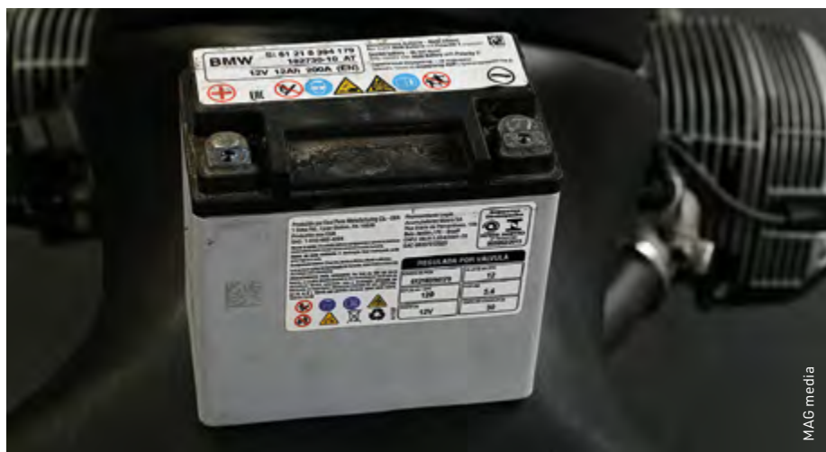
Gelaccu, uiterlijk identiek aan onderhoudsvrije loodzuuraccu
