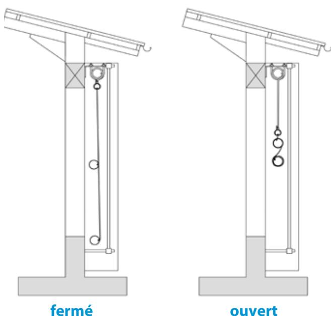
De par son enroulement supplémentaire, le Système 5 est encore plus stable et est très résistant au vent. Les profils en C galvanisés à chaud et revêtus de caoutchouc servent de haubans intérieurs et extérieurs.
