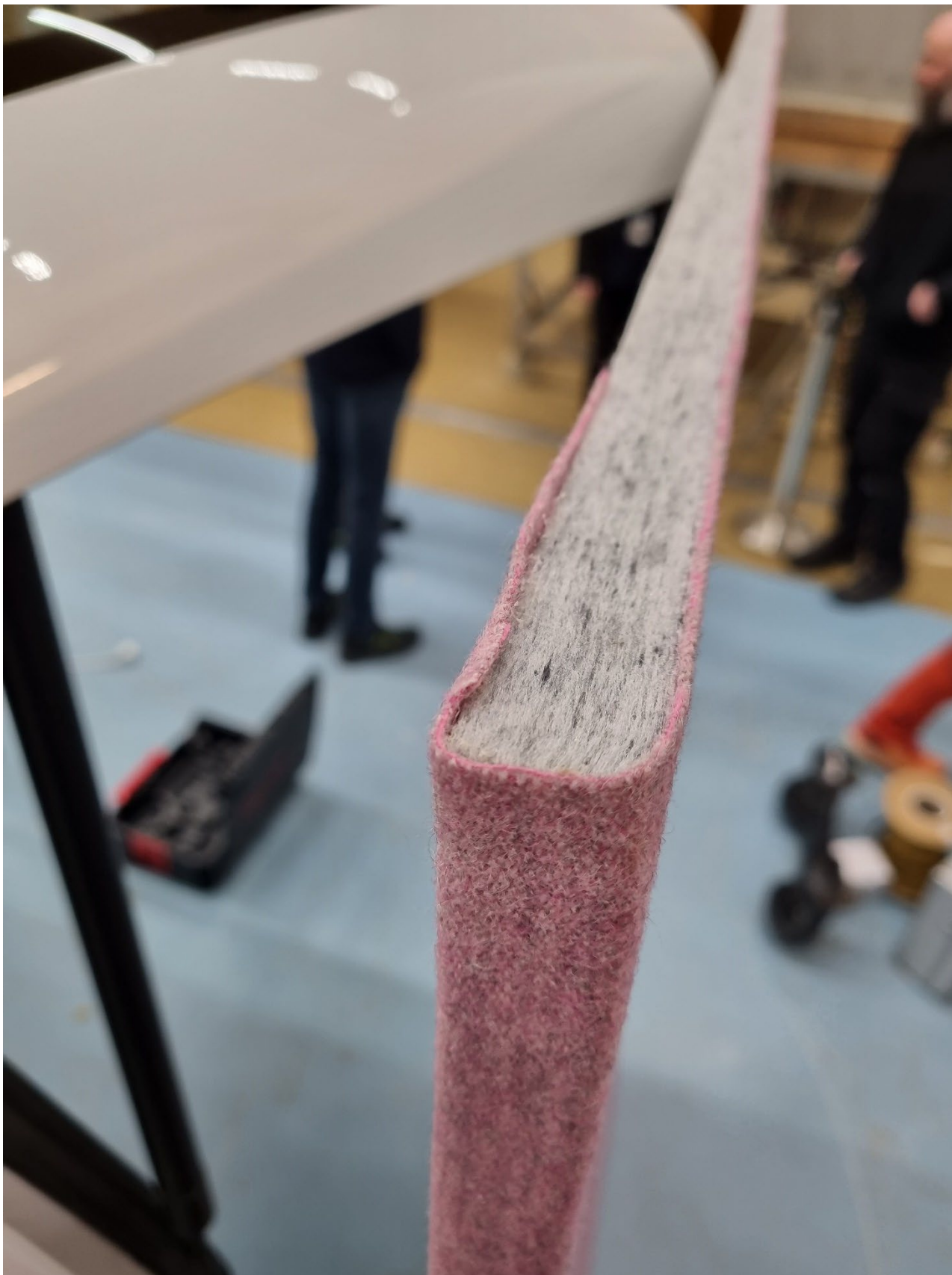
Figur 7: 25 mm porøs lydabsorbent fra bakveggen
