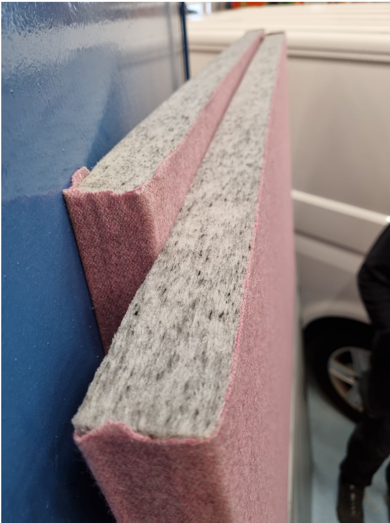
Figur 6: 50 mm porøs lydabsorbent fra sideveggene
