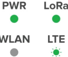
A fejegység először a mobil LTE hálózatra csatlakozik, majd azután a LoRa hálózatra. Ez legfeljebb 2 percent vesz igénybe.
